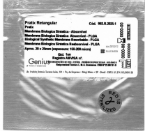
Figura 2 - Detalhe da embalagem primária na forma final com que a Pratix é comercializada. A embalagem com indicador químico (com o símbolo no centro) na cor amarela indica que ainda não foi esterilizado. A embalagem contendo o indicador na cor vermelha indica que o material já foi irradiado.
